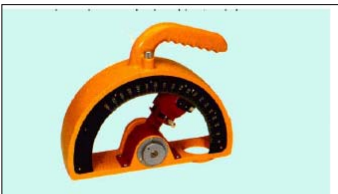
Photo (1.7) : Modèle P Pour matériaux légers, revêtements, enduits... Énergie de percussion ..... 0.880 J Direction ..... horizontale et verticale Résistance ..... de 5 à 25 Mpa
