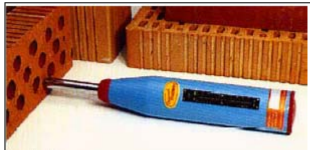
Photo (1.6) : Modèle LB Pour contrôler la qualité de produits en terre cuite. Énergie de percussion ..... 0.735 J
