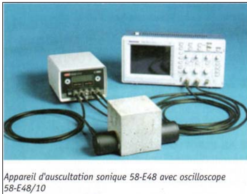
Photo (1.10) : Appareil d'auscultation sonore 58-E48 avec oscilloscope
