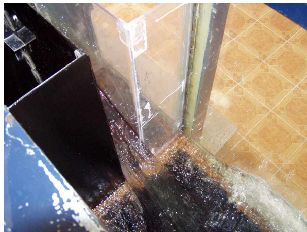
Photographie 3.14 Vue d'en haut de l'écoulement sortant du dispositif, qui indique la nature torrentiel de l'écoulement à l'aval du dispositif. La section contractée s'étend sur une certaine longueur à l'aval du dispositif avant de se disperser dans le canal d'amenée
