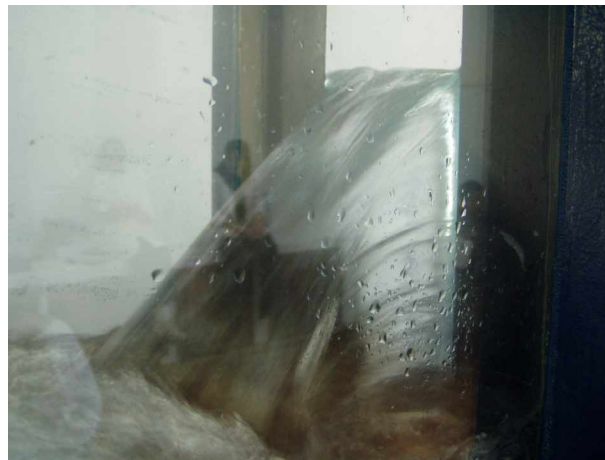
Photographie 3.10 : Vue de travers de la lame liquide déversante, montrant clairement la contraction latérale de l'écoulement.
