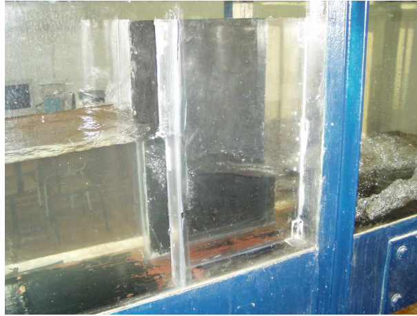
Photographie 3.13 montrant la nature quasi tranquille de l'écoulement à l'amont du dispositif et l'abaissement de la ligne d'eau à l'intérieur même du dispositif
