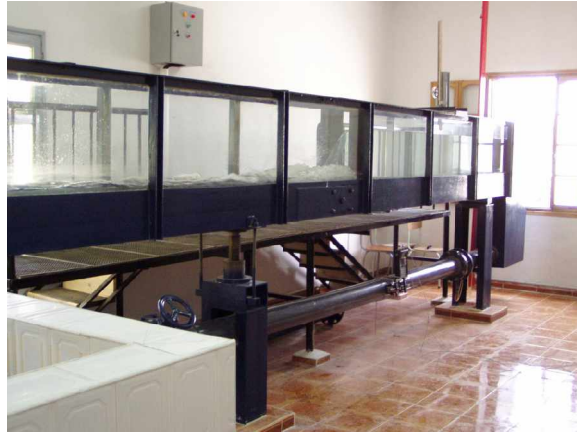
Photographie 3.1 : Vue d'ensemble du banc d'essais montrant : le réservoir de récupération des eaux, - la vanne de réglage des débits, - la conduite circulaire d'alimentation, - le bassin d'alimentation, - le canal de mesures
