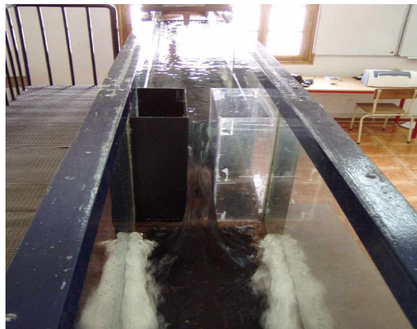
Photographie 3.16 : Vue montrant la nature de l'écoulement à l'aval du dispositif
