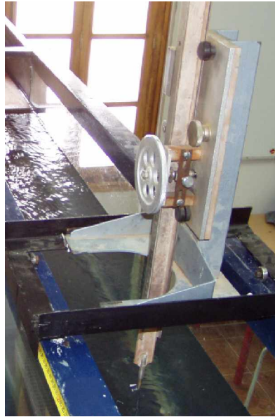
Photographie 3.5 : Vue de profil du limnimètre à vernier utilisé.
