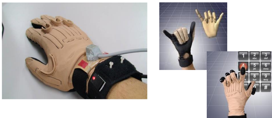
Figure 2.7. Gant de capteur équipé de bandes résistives et capteurs tactiles.
