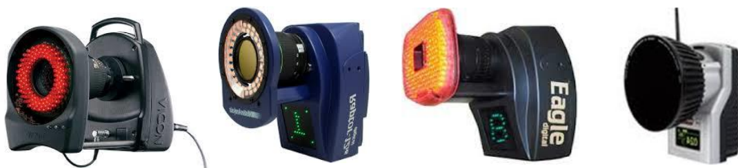
Figure 2.9. Exemple de 4 types de caméras utilisées pour la capture de mouvement optique.
