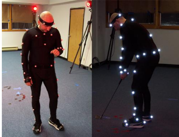
Figure 2.1. Costume utilisé pour la capture de mouvement optique.
