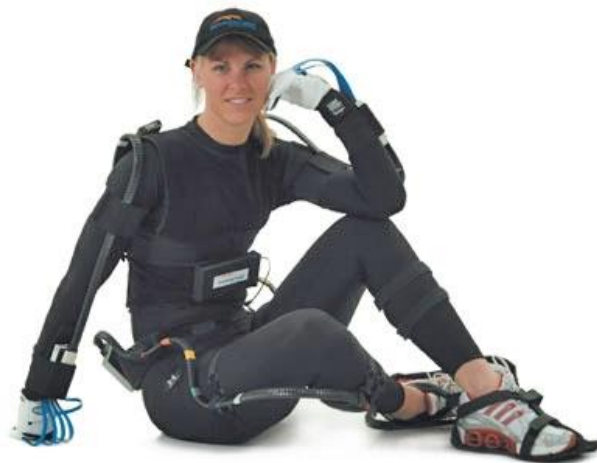
Figure 2.3. Costume utilisé pour la capture de mouvement à base de fibres optiques.
