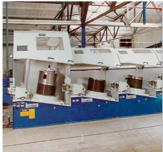
Figure I.15- deux images d'une chaîne de production réelle d'une tréfileuse multi-passes [17].
