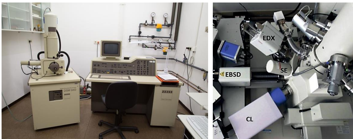
Figure II.9- Microscope électronique SEM-EBSD Zeiss 940 équipé d'un caméra EBSD.
