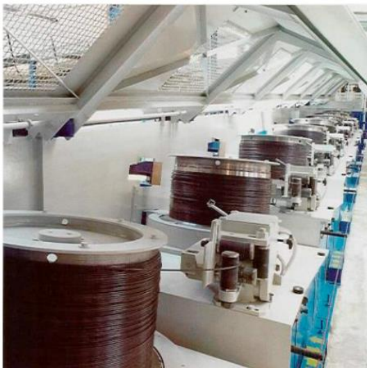
Figure I.15- deux images d'une chaîne de production réelle d'une tréfileuse multi-passes [17].
