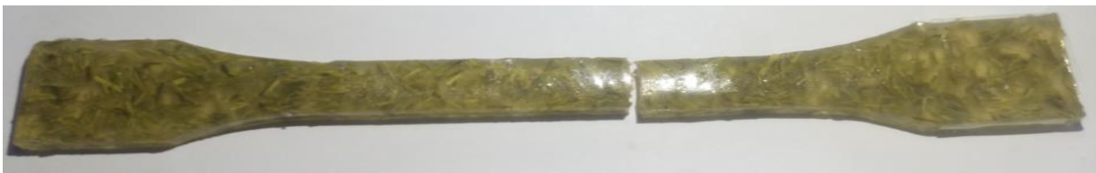
Figure II.12 : Éprouvette à base de résine Polyester/ Diss traité chimiquement rompue
