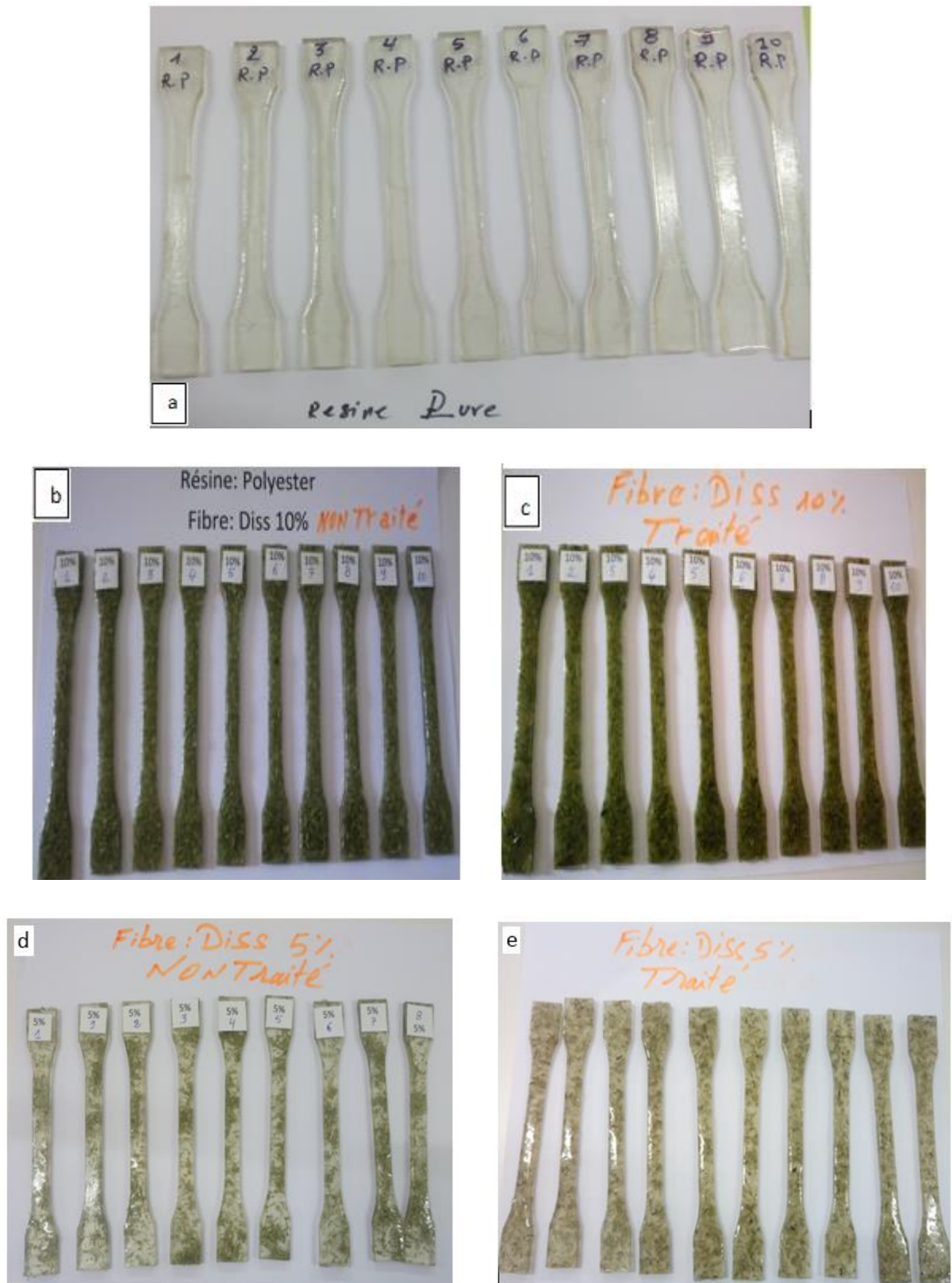
Figure II.9. Eprouvette de traction : (a) résine pure (b) Biocomposite à 10% de FNT (c) Bio-composites à 10% de FT (d) Bio-composites à 5% de FNT (e) Bio-composites à 05% de FT
