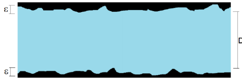
Figure. IV.6 Rugosité interne d'une conduite.
