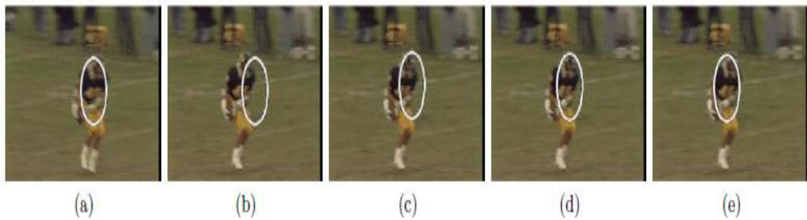
Figure 1.12 – L'itération du Processus de suivi par Mean Shift. (a) Localisation estimée de l'objet à l'instant t-1 , (b) Trame à l'instant t avec estimation de localisation initiale en utilisant la position d'objet précédente, (c), (d), Mise à jour de position en utilisant des itérations de Mean Shift, (e) Position finale de l'objet à l'instant t [21].
