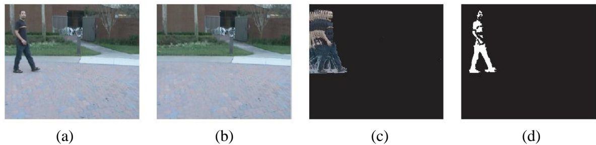
Figure 1.6 – Soustraction de fond en utilisant des mixtures de Gaussiennes [21] : (a) Image courante, (b) Modèle de fond utilisant les moyennes des gaussiennes de poids, (c) Moyenne des gaussiennes de poids minimal représentant l'objet en mouvement, (d) Résultat de la soustraction de fond
