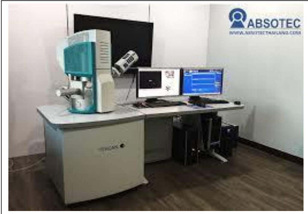
Figure 3 : Microscope électronique à balayage (Tescan Easy Probes avec EDX Bruker)
