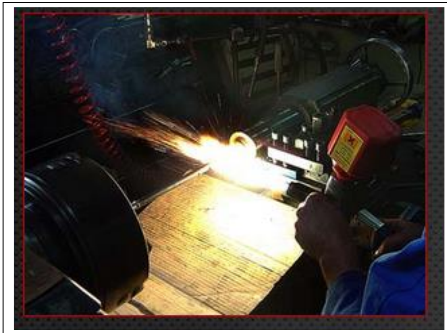
Figure 11 : Opération de recharge d'une portée à la MEI M'sila
