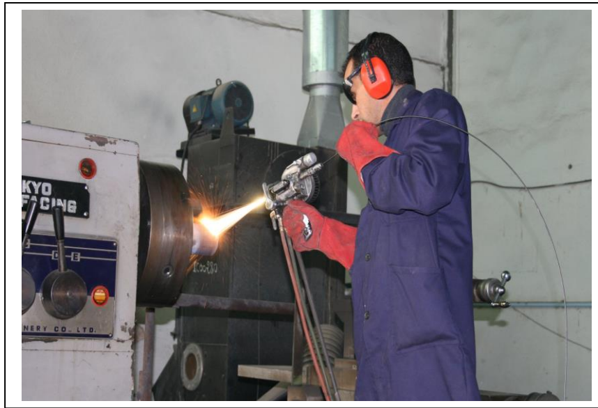
Figure 6: Poste de projection thermique à la flamme en fil (MEI)
