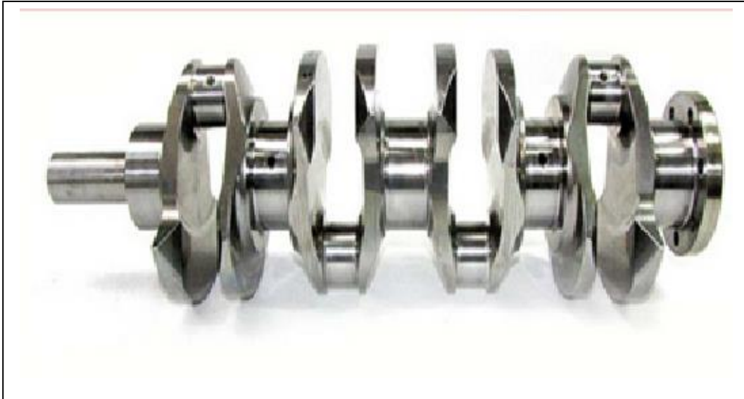
Figure 9 : Vilebrequin avant la recharge des paliers
