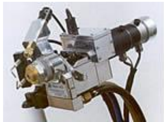
Figure 3 : Pistolet pour projection : a) céramiques. b) matériaux auto-fusibles [9]
