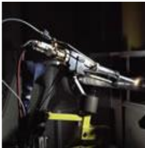
Figure 8 : Torche plasma HVOF «haute pression »[26]
