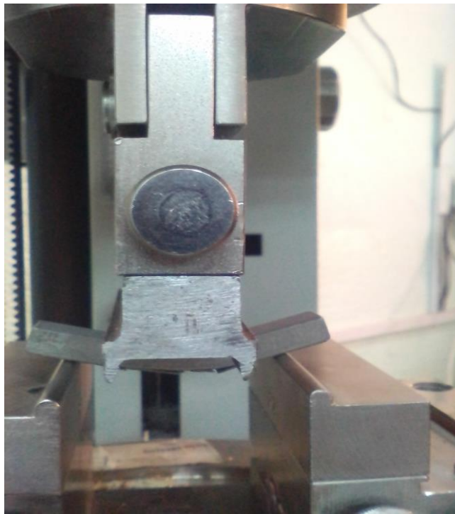
Figure 11: Machine d'essai de traction Zwick Roell Z100 utilisée en flexion 4 points
