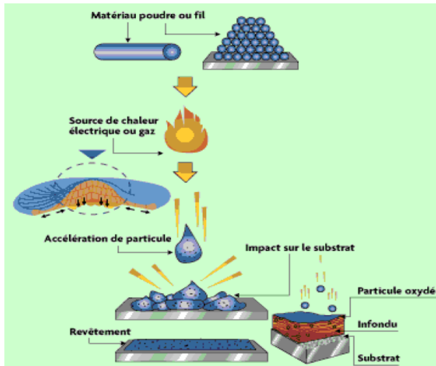
Figure 1 : Principe de base d'une projection thermique [5]
