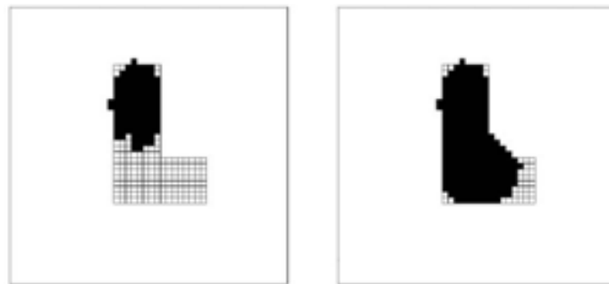
Figure 3.13-L-forme produite par un chromosome de deux gènes. (a) après expression du gène 1. (b) après expression du gène 2. (La forme cible est esquissée par les cellules vides).
