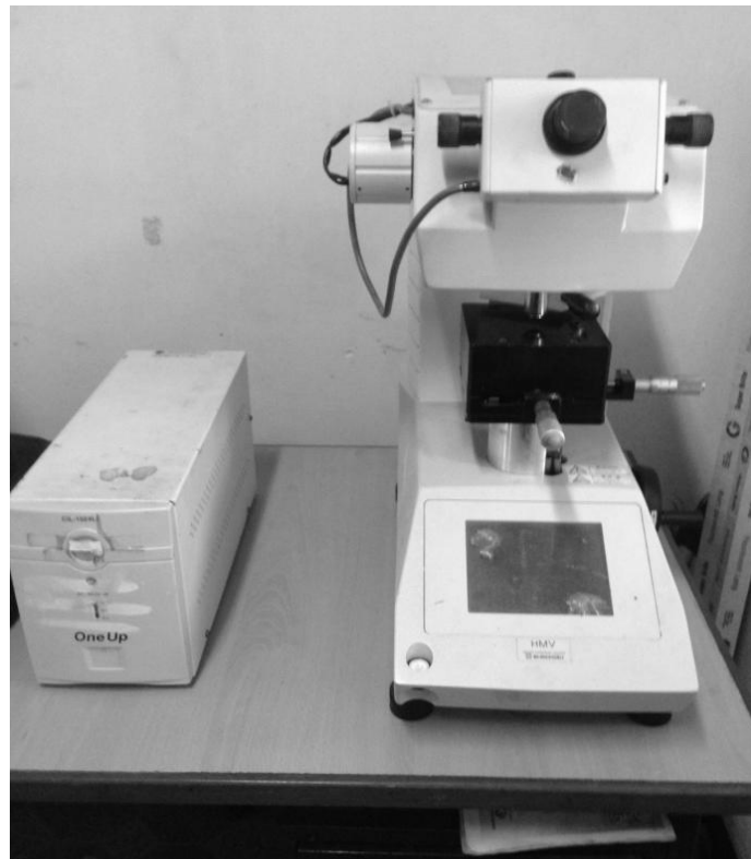
Figure IV. 14. Micro-duromètre Vickers de type Shimadzu (Modèle: HMV-2T).
