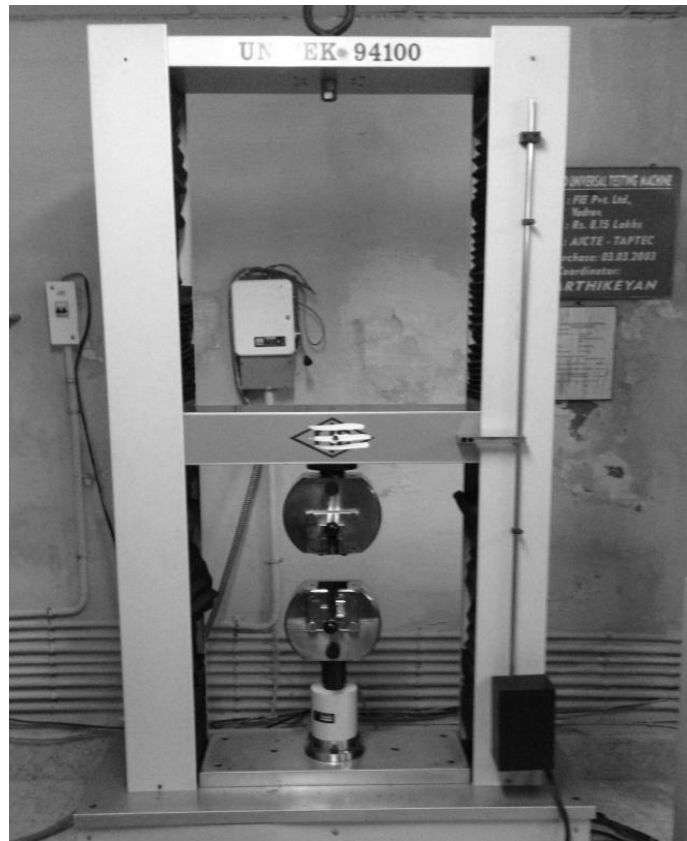
Figure IV. 11. Machine d'essai de traction, universelle asservie de type FIE–Bluestar (Modèle : UNITEK 94100).
