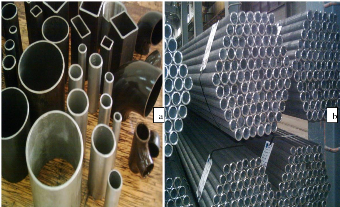
Figure I-9.( a ,b ). Tubes soudés par induction
