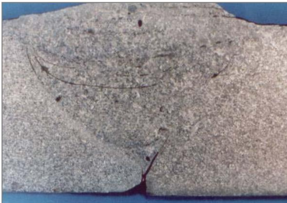
Figure II- 12. Manque de fusion entre passes [32].
