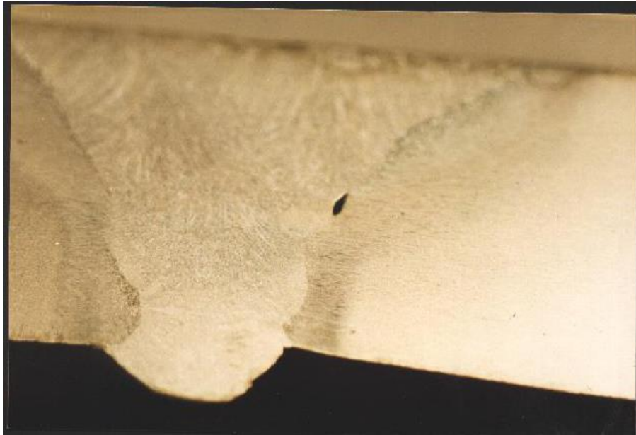
Figure II- 16 . Manque de pénétration [35] .
