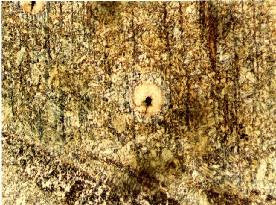
Figure II- 15. Porosité dans une soudure [35] .
