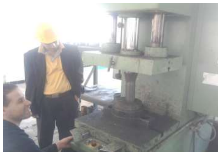
Figure III-38. Essai d'évasement (au cours de l'essai ).
