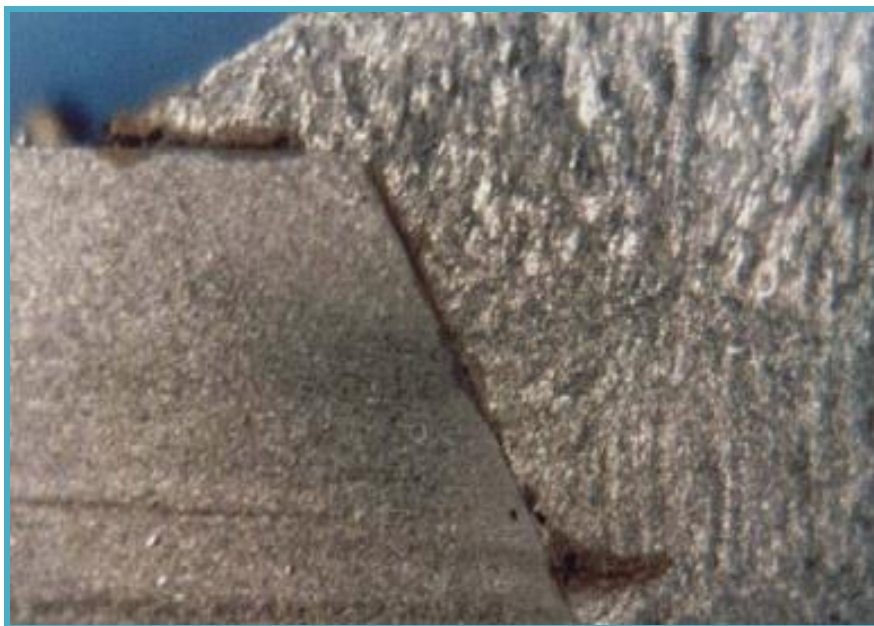
Figure II- 17. Manque de liaison [29] .
