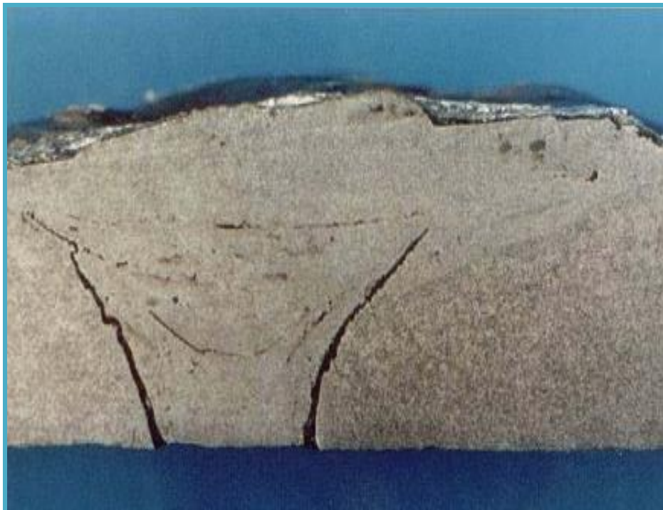
Figure II- 11. Fissures à froid [38] .
