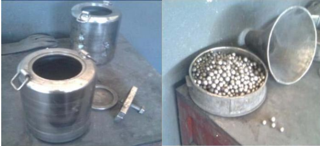
a) Broyeur en inox b) billes en acier rapide
