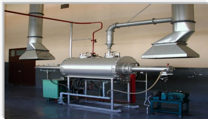
Figure III.1 Four à hydrogène
