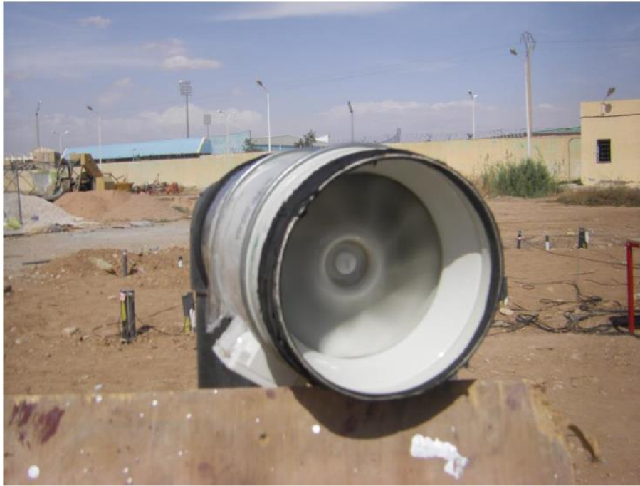
Figure 4. Extracteur d'air de débit variable.
