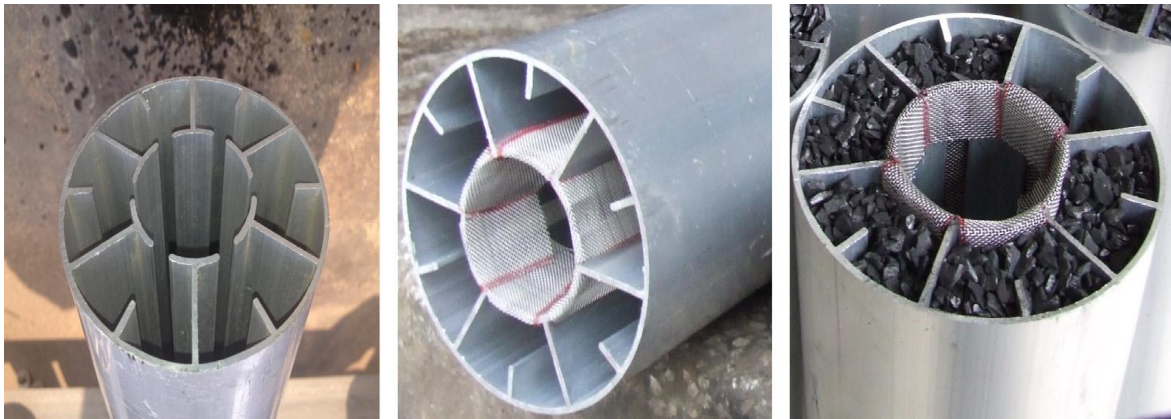
Figure 2.12. Configuration de l'enveloppe d'adsorption des tubes à ailettes [65].
