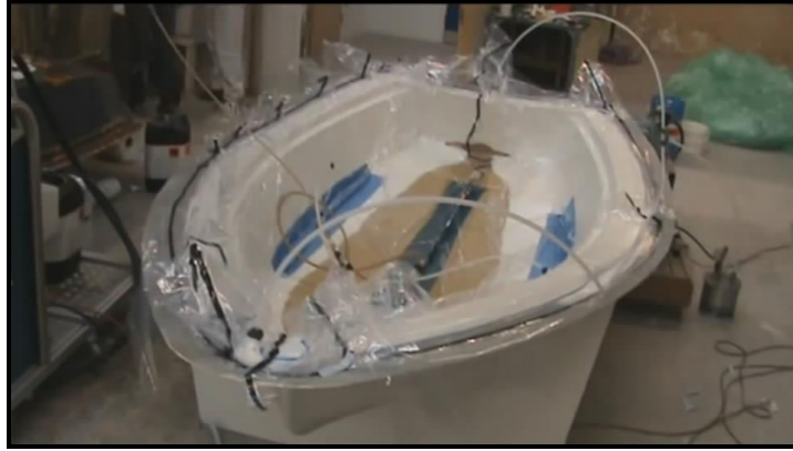
Figure 1.13 : Principe du moulage sous vide (source Marine Innovation Service).
