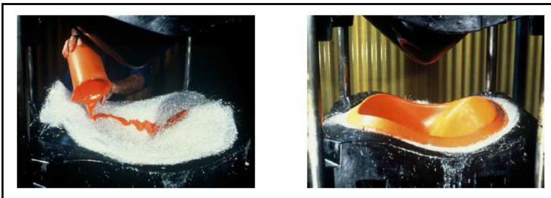
Figure1.16 : Principe du Moulage par compression à chaud de résine [7].
