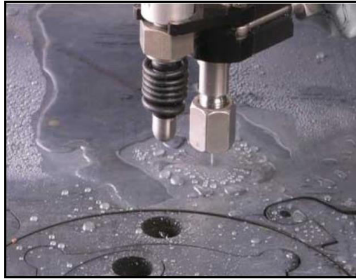
Figure 1.29 : Perçage par jet d'eau à haute pression (Source site usinnouvelle.com).
