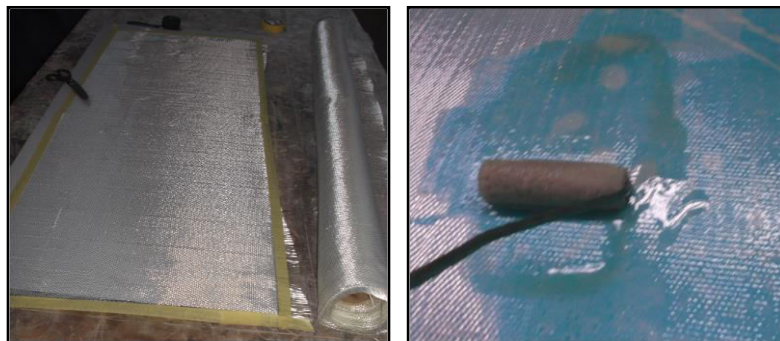
Figure 5.1 : Renfort en fibres de verre type «E» 450 g /m 2 , et préparation des plaques composites par le procédé de moulage par contact.
