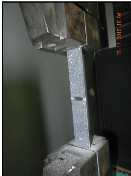
Figure 5.26 : Essai de traction sur les éprouvettes en matériau composite munies d'un trou elliptique.
