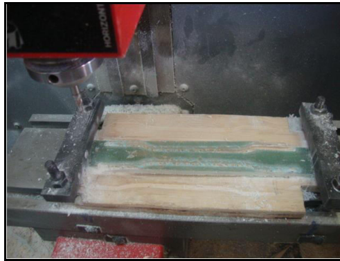
Figure 5.5 : Usinage des éprouvettes de traction polyester /mats par la fraiseuse à commande numérique.
