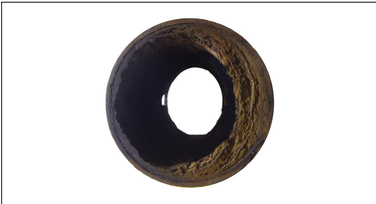
Figure I-1: La coupe transversale de « scale » d'une pipe [5].
