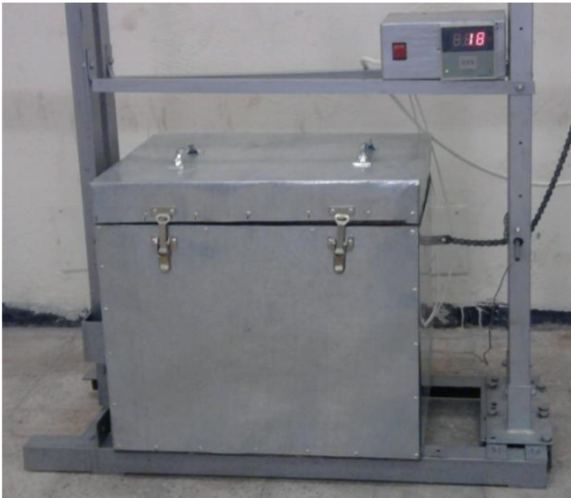
Figure III.11 : Le four électrique
