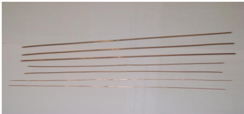
Figure IV.1 : Eprouvettes des fils de cuivre tréfilé.
