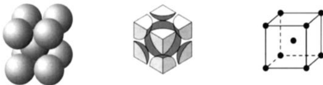
Figure I.8 : La structure cristalline cubique centrée
