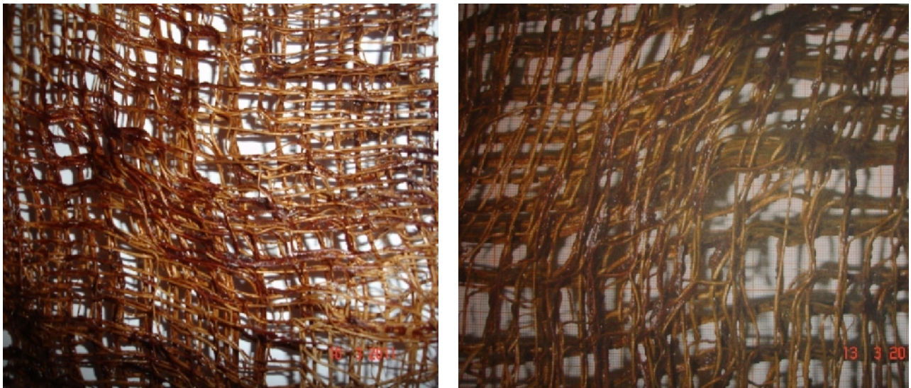
Figure (4.6) : Structure de la fibre végétale du palmier dattier
