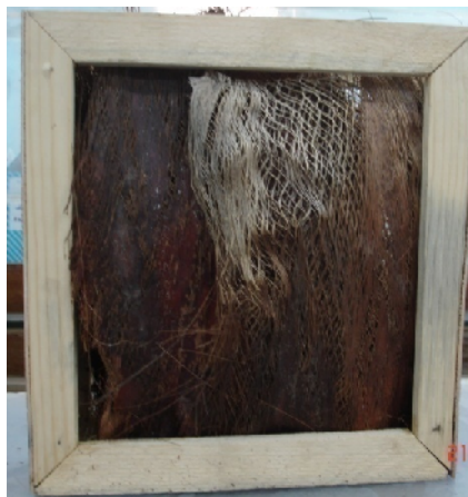
Figure (4.3) : enceinte d'humidification en bois Contenant des fibres végétales de palmier dattiers local
