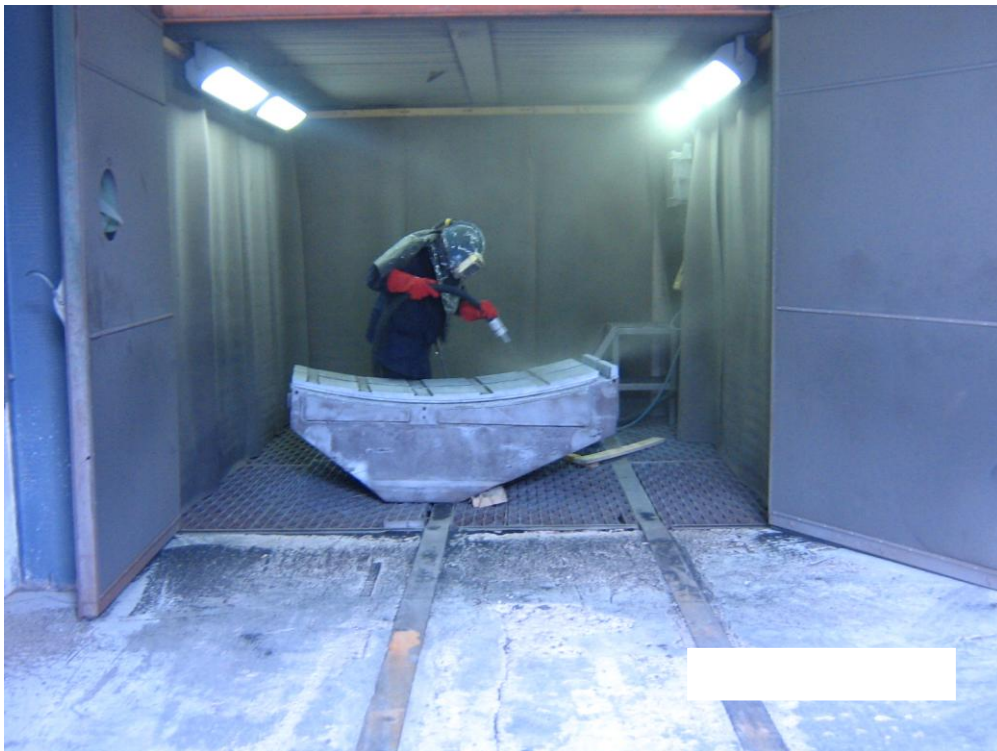
Fig. I.6: poste de sablage (MEI) *Maintenance des Equipements Industriels-M'sila.
