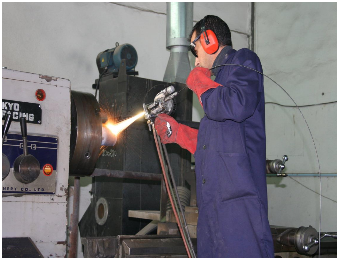
Fig. II.5: Poste de métallisation à la flamme en fil (MEI)
