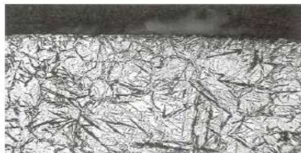
Fig. I.4: Couche carbonitrurée: structure martensitique et austénite résiduelle [33].
