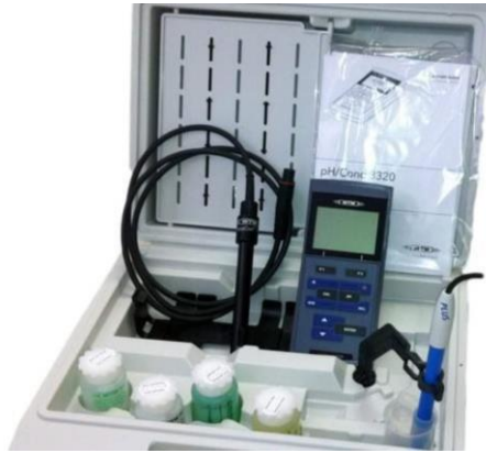
Figure 13 : L'appareil multi-paramètres pour mesurer les paramètre physico-chimique.
