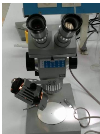
Figure 15 : Une loupe binoculaire utilisé pour identifie les macro- invertébré recolté dans les six stations de l'Oued Abiod.
