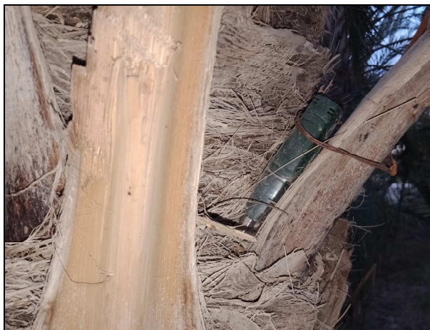
Photo 3 : Thermo-hygromètre placé dans la palmeraie de Zaatcha. (Originale, 2021)
