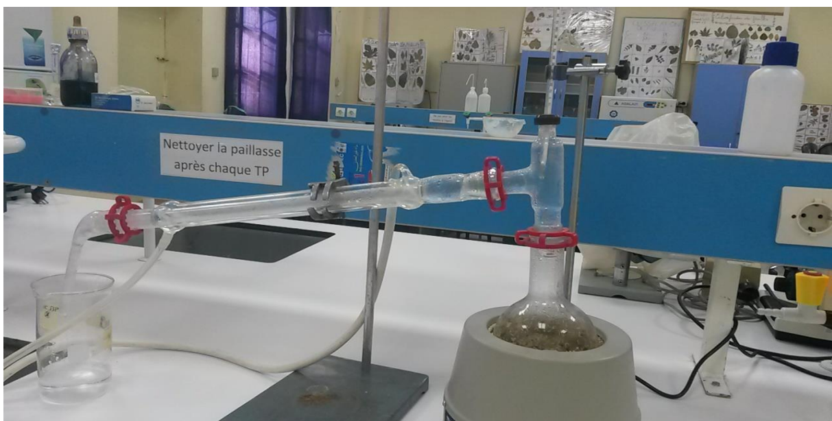
Figure 33: Montage de l'hydrodistillateur
