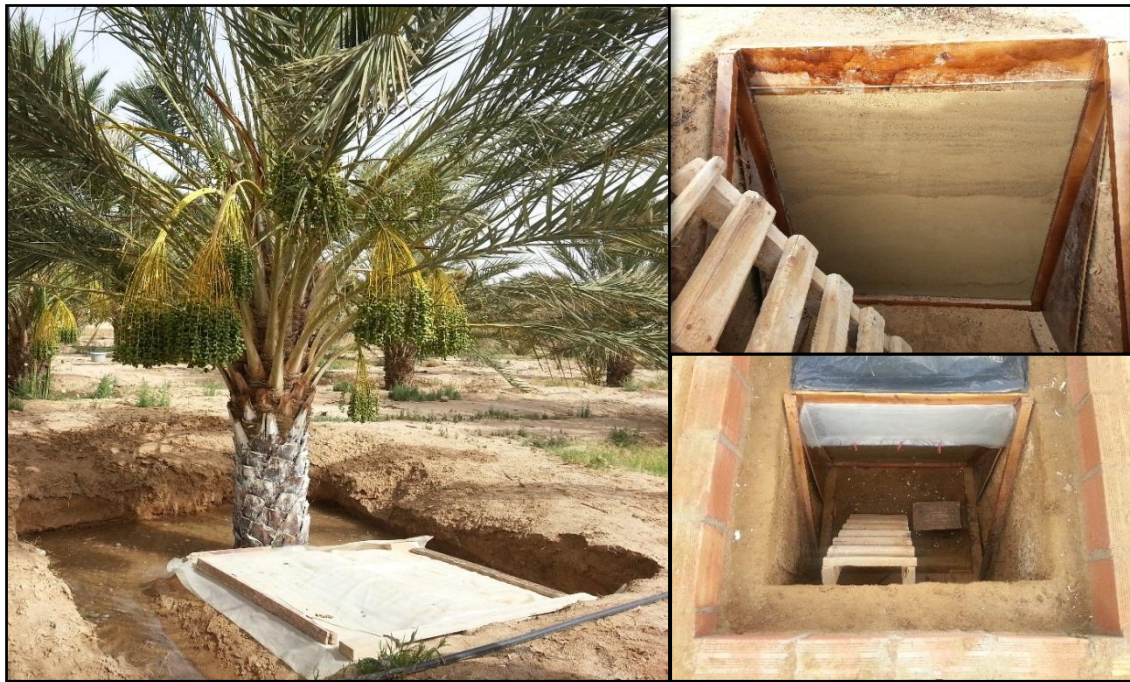
Figure 12: La mise en place de rhizotron
