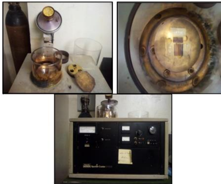
Figure. III.13.b: Banc de pulvérisation des plots d'or en forme de disque de 1mm de diamètre.
