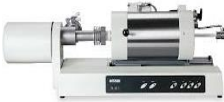
الشكل (8.III): جهاز قياس التمدد الطولي النسبي التفاضلي.
