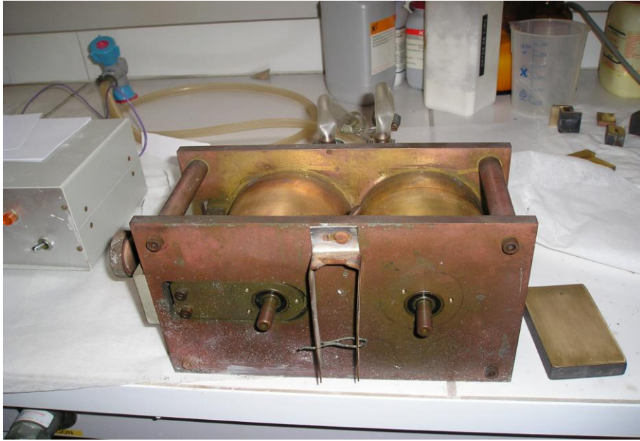
Figure III.1 : Appareillage d'hypertrempe utilisé pour la préparation de \text{Sb}_2\text{S}_3 vitreux.
