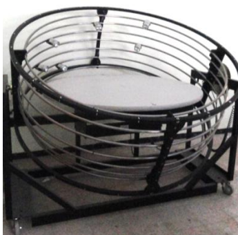
Figure I.4 : Héliodon de département d'architecture de Biskra. (Source : l'auteur)
