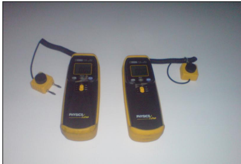
Figure 31 : Le luxmètre (Source: Auteur)
