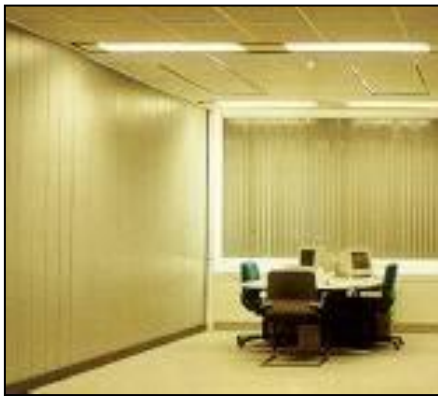
Figure 75: Espace éclairé à 300 lux avec une lumière chaude, (Source : http://www.energieplus-lesite.be/ )
