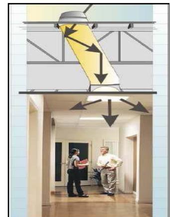
Figure 85 : Coupe sur un puits de lumière. (Source : Dr Anne Rialhe)
