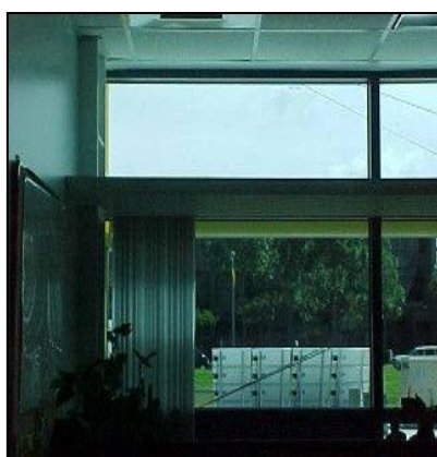
Figure 88 : Vue intérieure d'une étagère de lumière (Source : David. B. Floyd et al.)
