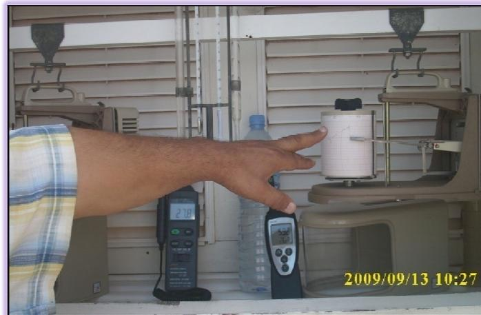
**Photo-VII.12 : Étalonnage de l'instrument de mesures utilisé**
