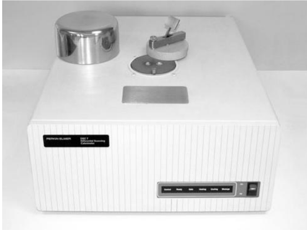
Figure A.1 : Calorimètre différentiel à balayage utilisé (DSC 7 - Perkin Elmer)
