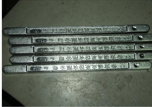
**Fig. III.3** Alliage de brasage Sn-37Pb sous forme de barre.
