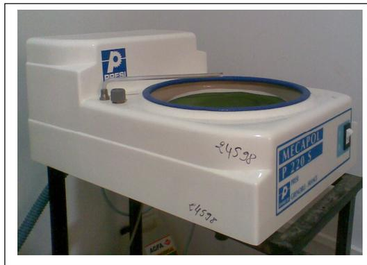
**Fig. III.5.** La polisseuse utilisée de type MECAPOL P 220 S.
