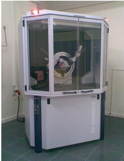
**Fig. III.10.** Diffractomètre de type (D8 ADVANCE).
