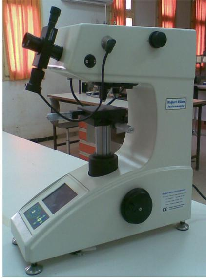
Fig. III.12. Le microduromètre utilisé de marque Wolpert Wilson.
