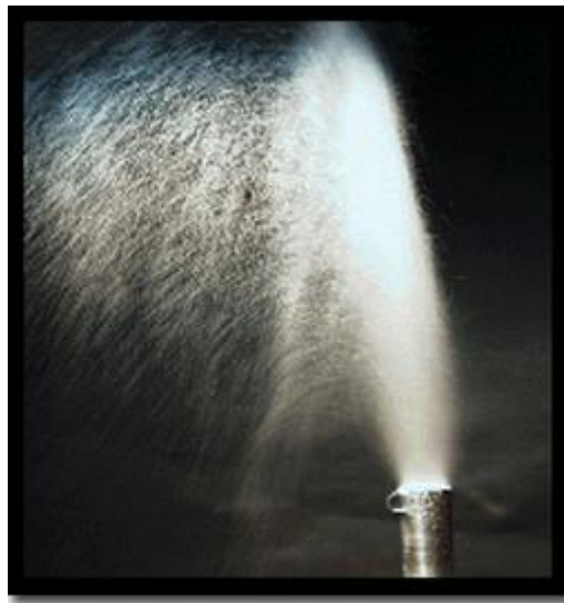
FigII.1 : Pulvérisation ultrasonique des liquide [82]
