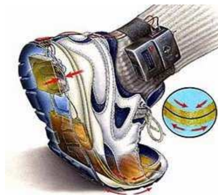
Figure I.5 : pastilles piézoélectriques intégrées dans une chaussure [40]
