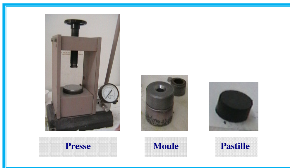
Figure II.3.Appareillage utilisé dans le compactage
