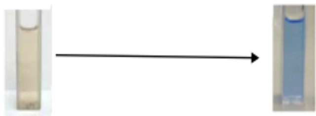
Figure 5: Changement de couleur du à une réduction du molybdate d'ammonium (Jaune) avec le noyau phénol du CFR (Bleu) (Agbor et al., 2014).
