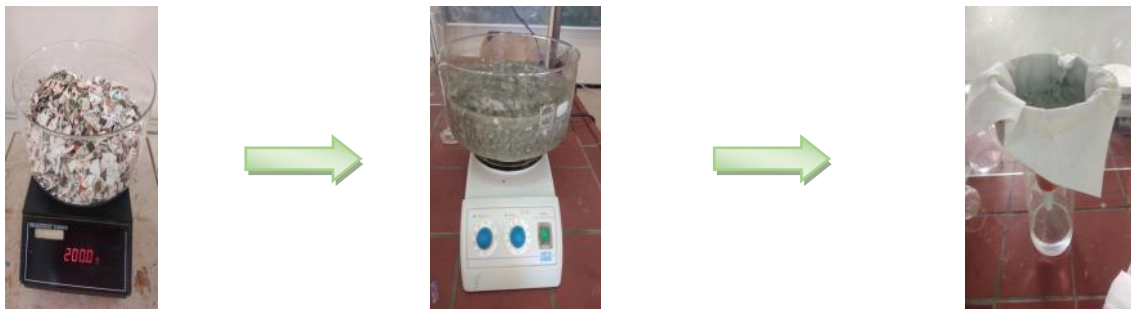
Figure II.2 : Les étapes de préparation des fibres traitées par l'eau javel.
