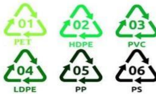
Figure I.3 : Codes d'identification des produits plastiques recyclables [127]
