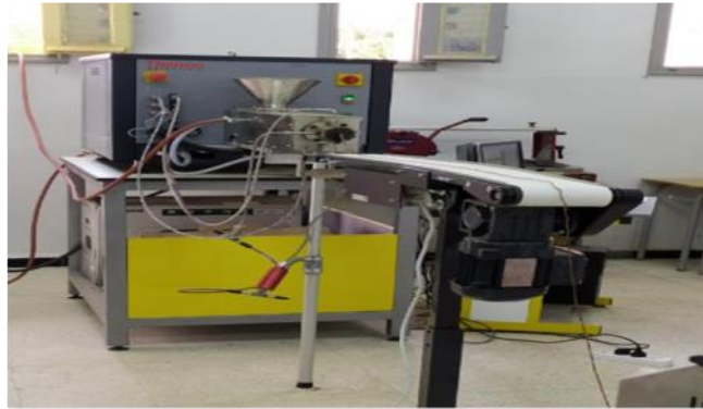
Figure II.4 : Extrudeuse de type PolyLab.
