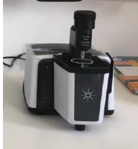
Figure II.12 : Spectrophotomètre Agilent Cary 630 FTIR.
