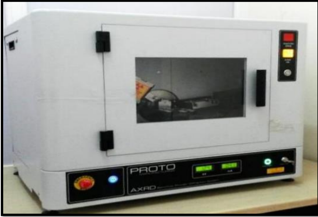
الشكل (14.II): جهاز الأشعة السينية (DRX) المستخدم [39].
