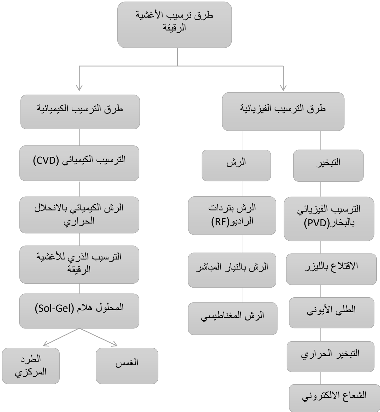
الشكل (4.II): مخطط يوضح طرق ترسيب الطبقات الرقيقة [19].
