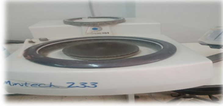
الشكل(7.II):صورة فوتوغرافية لالة الصقل من نوع Megabel pressi233.
