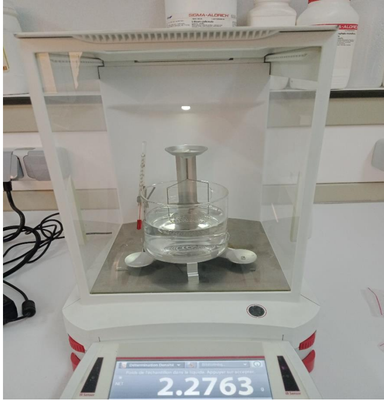
الشكل (12.II): صورة فوتوغرافية لجهاز قياس الكثافة OHAUS.
