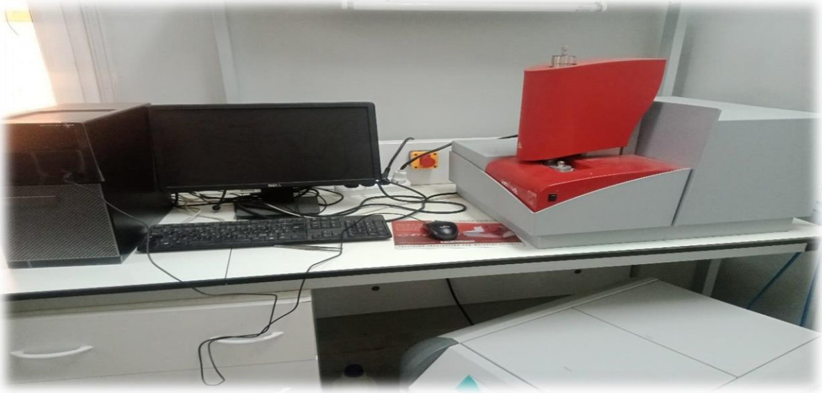
الشكل (9.II): صورة فوتوغرافية لجهاز المسعر التفاضلي الماسح DSC.
