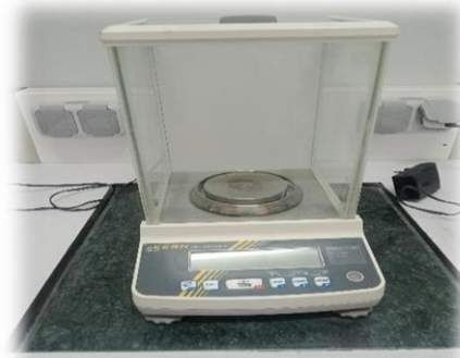
الشكل (1.II) : صورة فوتوغرافية لميزان الدقة من نوع KERN.
