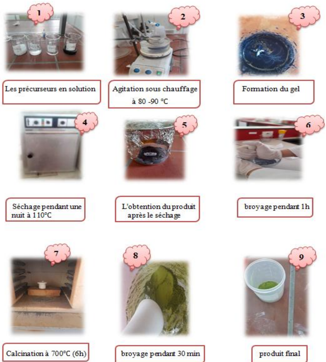
Figure III.2: Les étapes de la synthèse \text{BiCr}_{1-x}\text{Al}_x\text{O}_3 par la méthode citrate.
