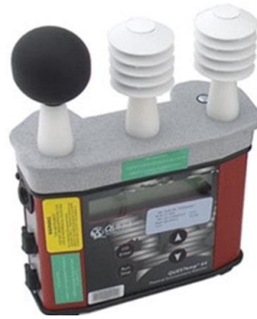
الشكل 3-6: جهاز مراقبة درجة حرارة البصيلة الرطبة الكروية (WBGT) لقياس الحرارة البيئية، المصدر: ( https://www.osha.gov/heat-exposure/hazards )
