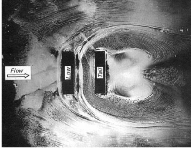
الشكل 4-18: انسياب حول مبنى مرتفع مع مبانٍ منخفضة عكس اتجاه الرياح، المصدر: (T.R.Oke, 1987)
