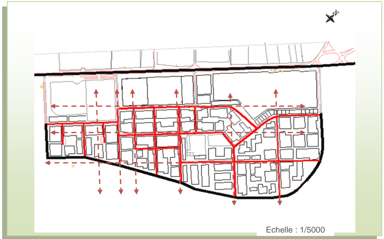
Figure n°93 : Plan de réseau de voies -lotissement Gharassa- élaboré sur la base de PDAU Bechar. Source : U.R.B.A.T Béchar, 2009.
