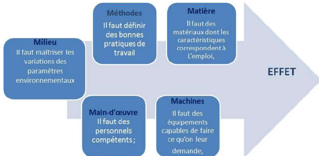
Figure 06 : La méthode des 5 « M » qui constituent les familles des paramètres de fabrication Source : Auteure, 2020
