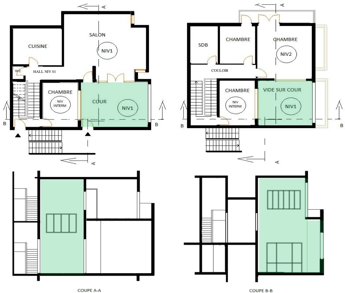
Figure 8-5. Plan et coupes permettant de voir les deux entrées, la composition en duplex et la cour à double hauteur (source : auteur)
