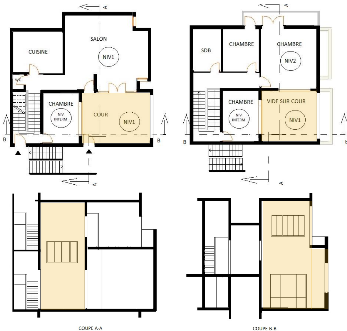
Figure 5-24. Plan et coupe d'un plan-type d'un logement F4 avec marquage de l'espace cour. (source : auteur)
