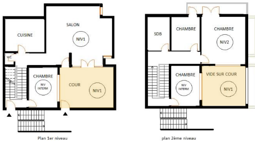
Figure 5-28. plan type d'un duplex F4. Source : relevé du logement par l'auteur
