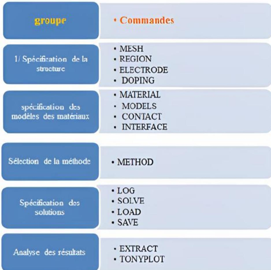
**Figure IV.3:** Ordre des groupes de commandes fondamentales dans le logiciel ATLAS.
