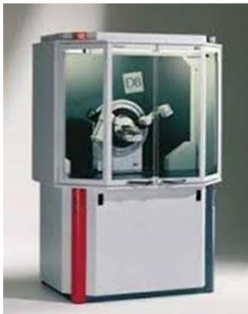
*Figure (II.4): le diffractomètre utilisé de type siemens Bruker D8*
