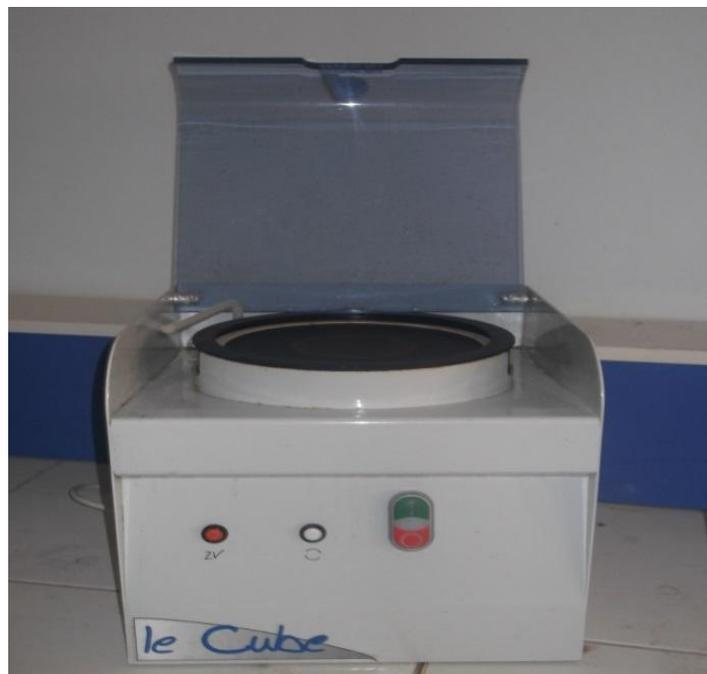
*Figure (II.2): Appareil de polissage*
