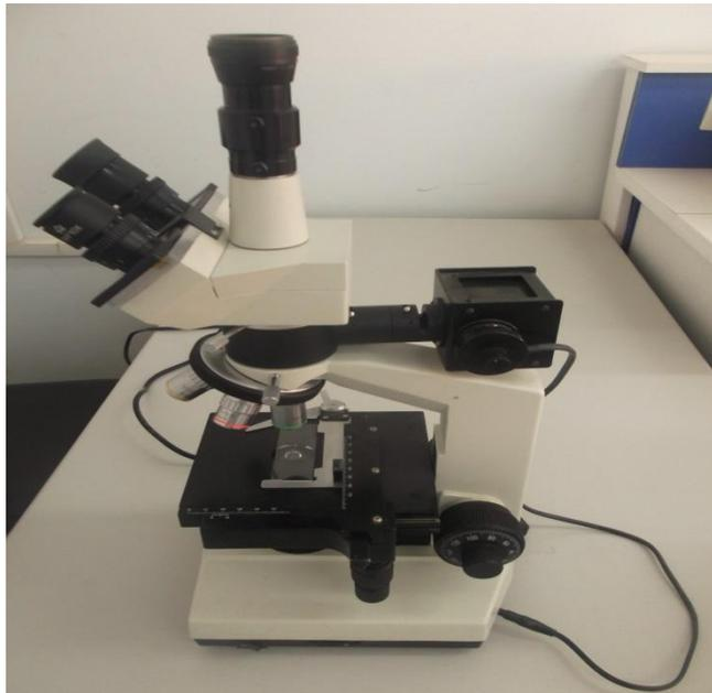
*Figure (II.3):Appareil de microscopie optique*
