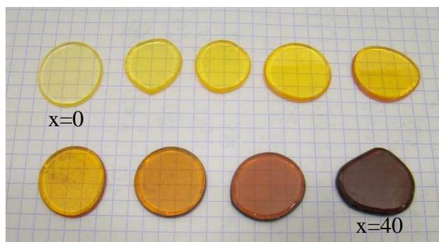
**Figure III-1: Photographie des échantillons du système SLM :  $(80-x)Sb_2O_3-20Li_2O-xMoO_3$ .**
