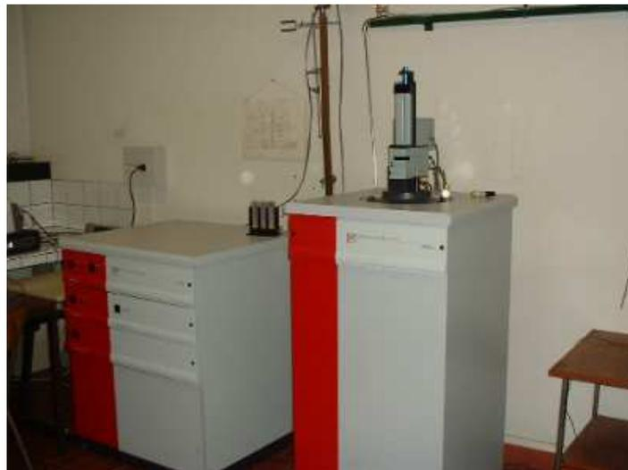
*Figure IV-2: Magnétomètre à détecteur SQUID modèle MPMS-XL de Quantum*
