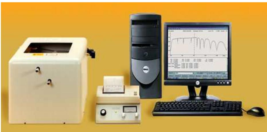
**Le modèle Metricon 2010 M / Prism Coupler** utilise des techniques optiques de pointe. Ils mesure rapidement et précisément l'épaisseur et l'indice de réfraction du guide d'onde ainsi que le biréfringence de diélectrique et des films de polymères. Pour les films minces et de nombreuses applications de guide d'ondes optiques.
