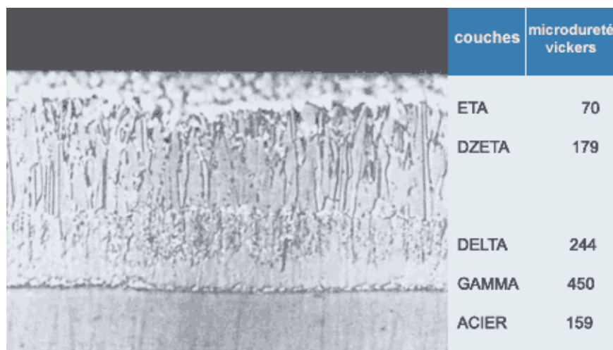
Fig. II. 1 : Vue en coupe transverse de phases formées après la galvanisation de l'acier.
