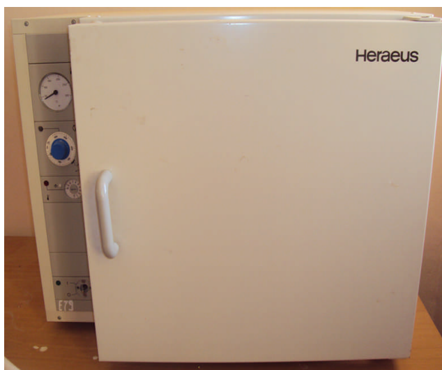
Figure 3: étuve de recuit de type Heraeus
