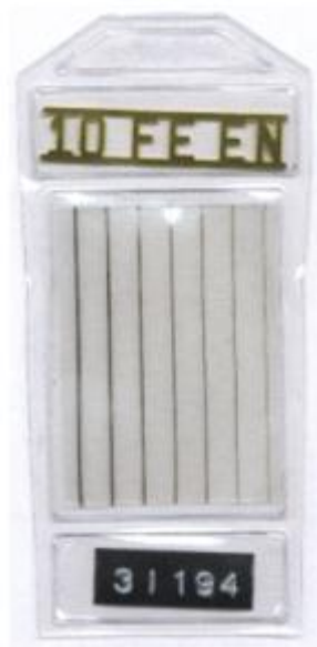
Figure 88 : indicateurs de qualité d'image (IQI)
