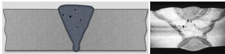
Figure 34c : Inclusions gazeuses porosités uniformes.
