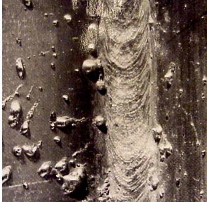
Figure 45 : Projections sur le métal de base.
