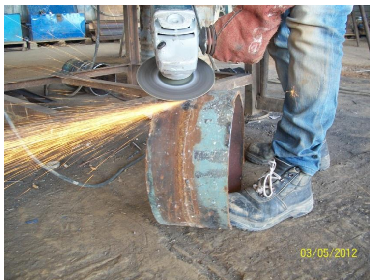
Figure 118 : Limage du cordon de soudure.
