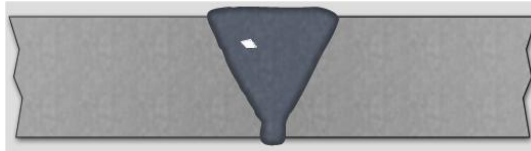
Figure 35c : Inclusions de cuivre.
