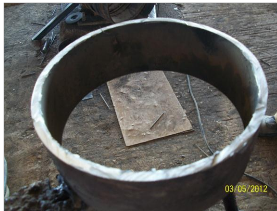
Figure 59 : Etat irrégulier de la surface transversale.
