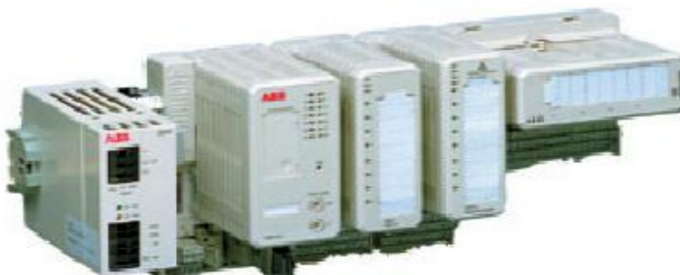
Fig. III.9: Les carte d'entrées sorties S800
