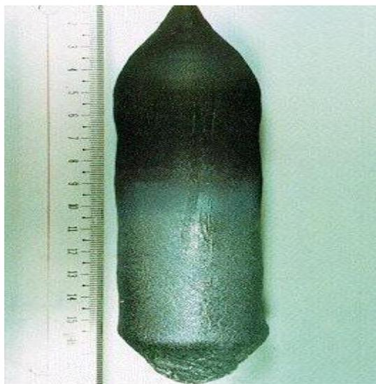
Figure I.5 : Cristal de GaAs obtenu grâce à la méthode Czochralski
